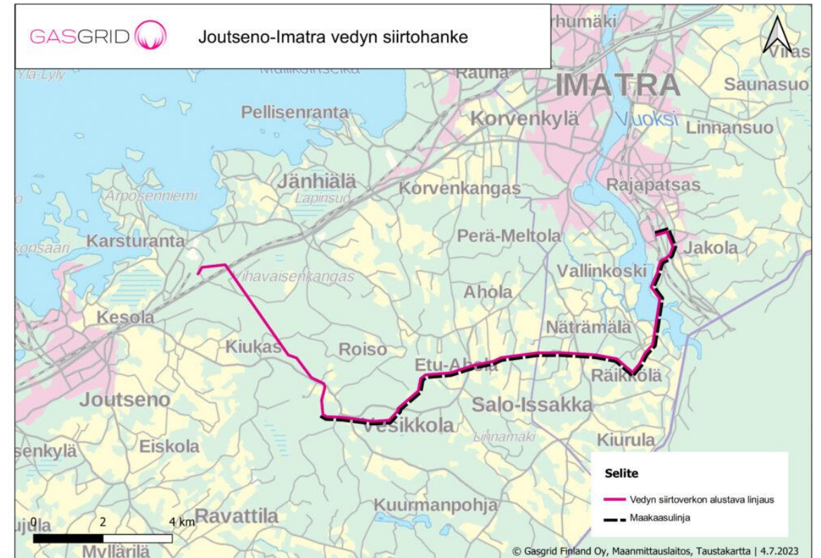
Kuva. Joutseno-Imatra vedyn siirtohanke. Uusi vetyputki kulkee Imatran puolella samassa käytävässä maakaasulinjan kanssa. Gasgrid Finland Oy. 2023.
